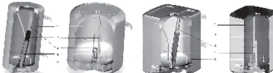
Рис. 1' ЭВН Atlantic в разрезе и его составные части
